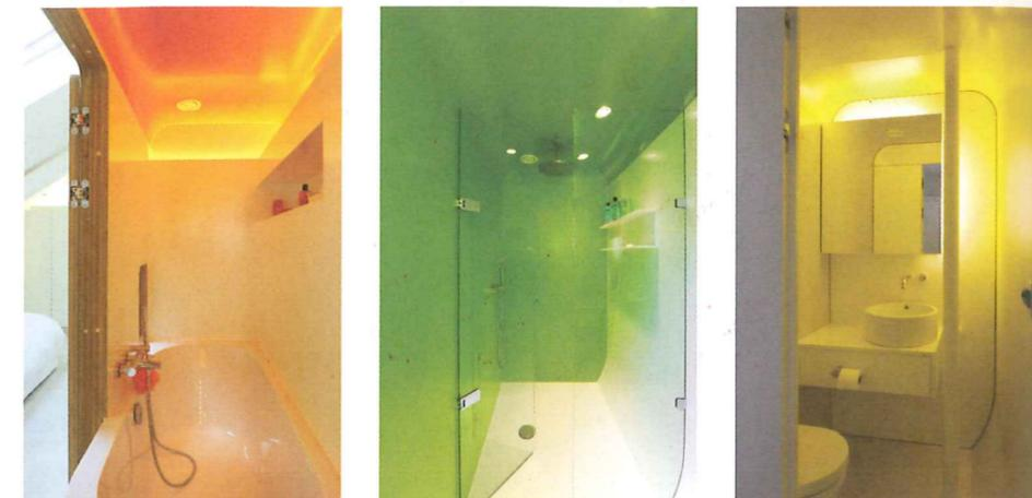
À l'extérieur de la caravane, le blanc domine. À l'intérieur, par contre, les couleurs explosent. De petits hublots diffusent la lumière chaude et colorée vers la pièce principale. Dans toutes les pièces, l'éclairage est indirect et est assuré par des tubes LED à intensité variable.
